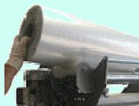
**Sistema Rilevazione Automatica di fine bobina** è un sistema di sicurezza che blocca la pellicola tra i rulli quando la bobina è finita, evitando così possibili danneggiamenti e consentendo un più veloce cambio bobina.
