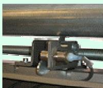
**Centratore manuale delle bobine,** superiore ed inferiore
