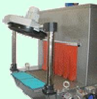
**Rulli Pressatori Laterali** in uscita dal tunnel di retrazione, in caso di chiusura completa del fardello
